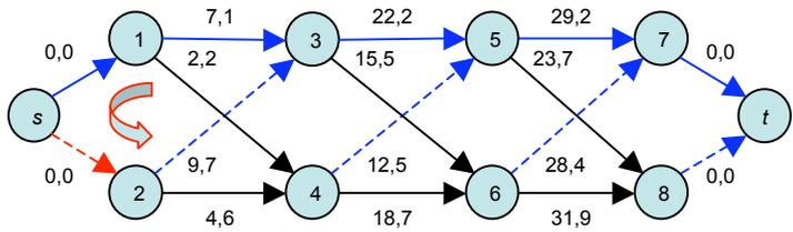
Il valore massimo ammissibile per  $\delta$ , pari a 1, è dettato dai valori di soglia degli archi  $s1, 13$ . Eseguito l'aggiornamento, la soluzione migliora di  $2,6\delta = 2,6$  e restituisce il cammino riportato di seguito.
