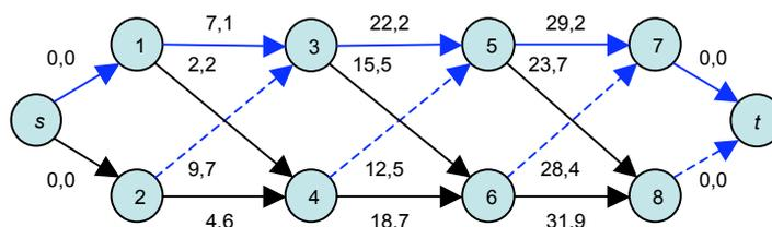
*Soluzione.* Possiamo prendere come soluzione ammissibile iniziale il cammino  $(s1, 13, 35, 57, 7t)$ . Per costruire una base (degenere) completiamo quest'insieme in modo da formare un albero ricoprente  $B$ . Ad esempio possiamo aggiungere gli archi 23, 45, 67, 8t. Per sapere se la soluzione è ottima dobbiamo calcolare i potenziali  $y$  ai nodi applicando per ogni  $uv \in B$  la formula  $c_{uv} + y_u - y_v = 0$  dopo aver fissato uno dei valori ad arbitrio, per esempio  $y_s = 0$ .
