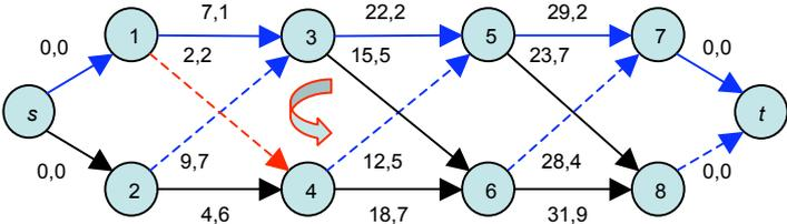
Il valore massimo ammissibile per  $\delta$ , pari a 1, è dettato dai valori di soglia degli archi 13, 35. Eseguito l'aggiornamento, la soluzione migliora di  $-14,6\delta = -14,6$  e restituisce il cammino riportato di seguito.
