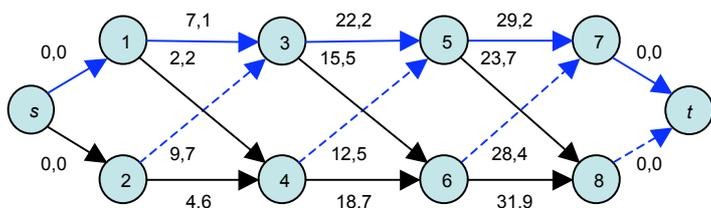
*Soluzione.* Possiamo prendere come soluzione ammissibile iniziale il cammino  $(s1, 13, 35, 57, 7t)$ . Per costruire una base (degenere) completiamo quest'insieme in modo da formare un albero ricoprente  $B$ . Ad esempio possiamo aggiungere gli archi  $23, 45, 67, 8t$ . Per sapere se la soluzione è ottima dobbiamo calcolare i potenziali  $y$  ai nodi applicando per ogni  $uv \in B$  la formula  $c_{uv} + y_u - y_v = 0$  dopo aver fissato uno dei valori ad arbitrio, per esempio  $y_s = 0$ .
